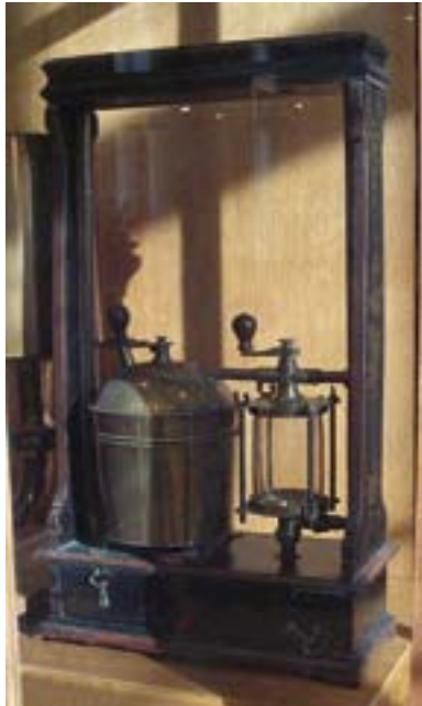
Bomba de incendio, máquina de Savery (1698), construcción del siglo XVIII (Fotografía: Wikimedia Commons)
